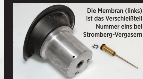
Äußerlich fallen Stromberg-Vergaser durch die etwas gedrungene Form der Glocke auf
