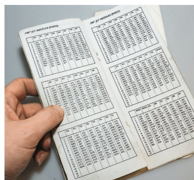
Nachschlagewerk: Die Needle Charts geben Auskunft über alle Nadelformate
