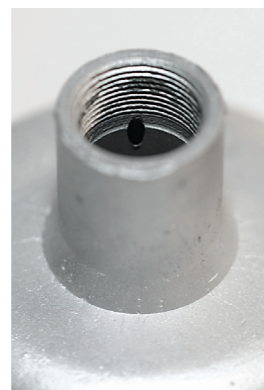
Die Verschraubung des Kolbendämpfers gibt es mit und ohne Loch. Die Variante links im Bild gehört zu einer Glocke mit Entlüftungsbohrung
