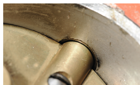
Hier reibt die Welle in der Lagerung, die Falschlufft kann zu Motorschäden führen
