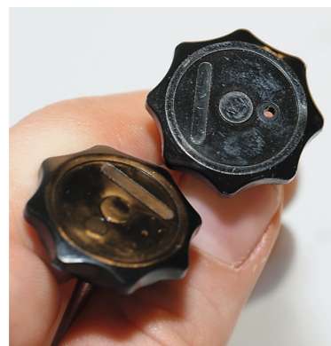
Die Verschraubung des Kolbendämpfers gibt es mit und ohne Loch. Die Variante links im Bild gehört zu einer Glocke mit Entlüftungsbohrung
