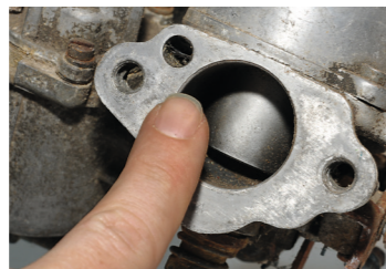
Auch mit montiertem Luftfilter muss diese Bohrung unbedingt frei bleiben
