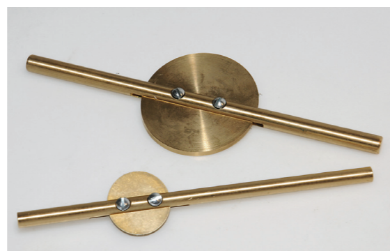
Neue Drosselklappenwellen hat der Profi auf Lager oder fertigt sie auf Maß, ebenso die passenden Drosselklappen
