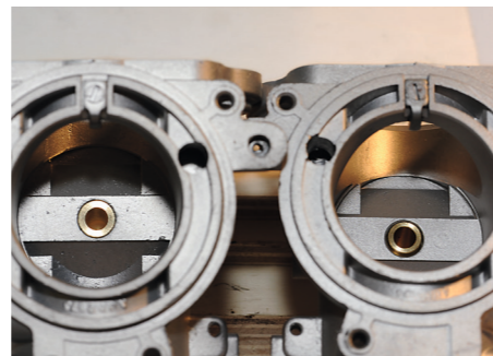
Entsprechend sind auch die Düsenführungen unterschiedlich. Rechts die verstellbare Variante
